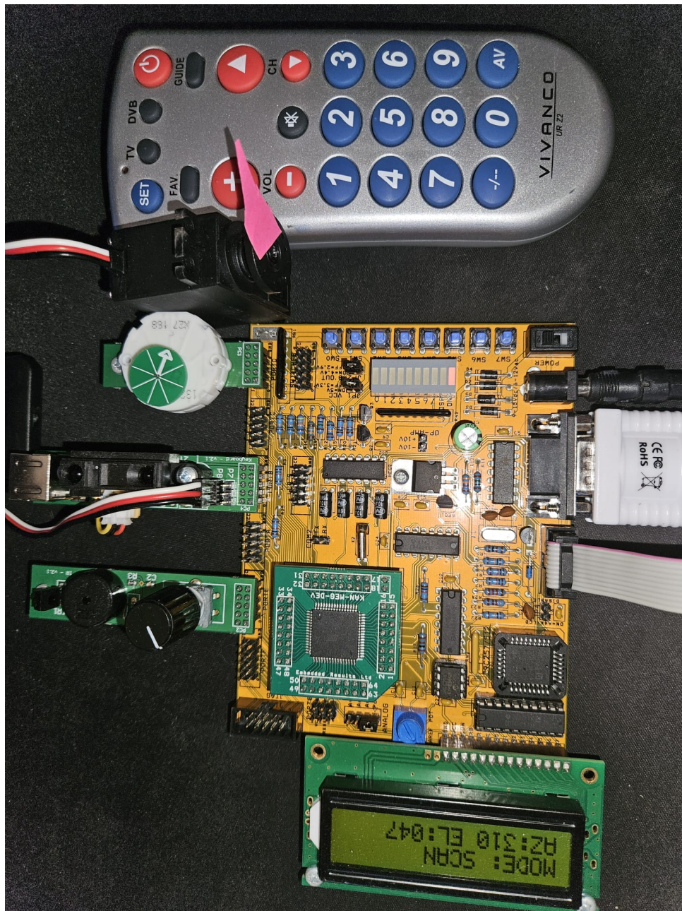
FIGURE 1 – Vue d’ensemble du montage sur la carte STK-300 avec les modules périphériques.
